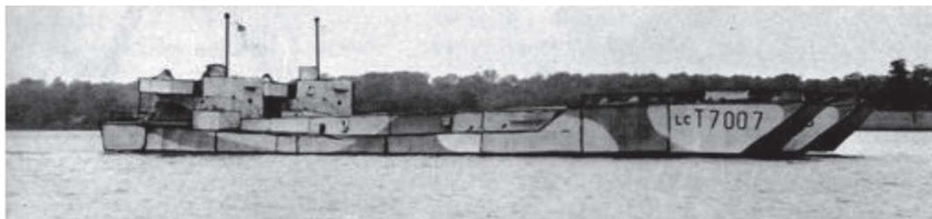
Deux faux LCT (Landing Craft Tank) péniches de débarquement en bois de 175 pieds (53 m) de long et pesant 5 tonnes. Noter le camouflage et les immatriculations.
